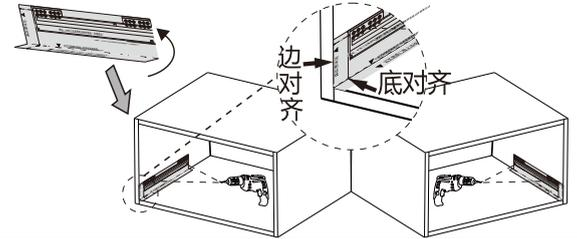
若柜已打预埋孔, 则滑轨的第一个孔与预埋孔的第一个孔对应安装
