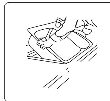
第四步：① 再次检查水槽在台面上的位置，并在水槽边缘打上适量的玻璃胶；
