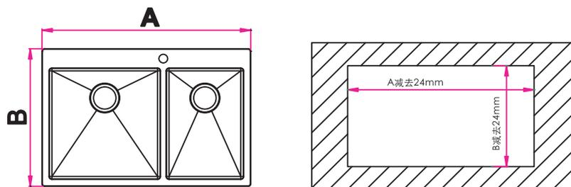
第二步：① 画出切割线，切割安装孔；
